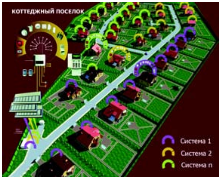
ОПС коттеджного поселка на базе радиосистемы СТРЕЛЕЦ®
