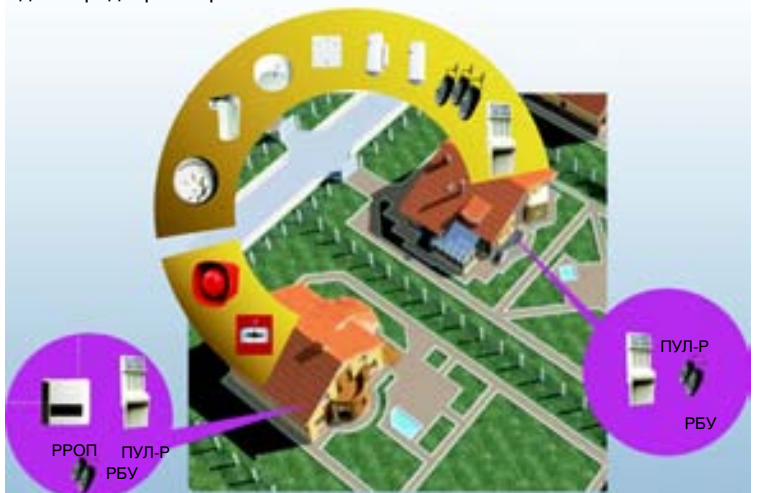
Охрана нескольких соседних коттеджей с использованием одного радиорасширителя
