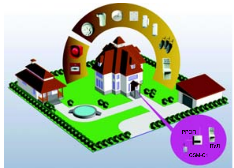
Охрана коттеджа и вспомогательных строений с использованием одного радиорасширителя.
