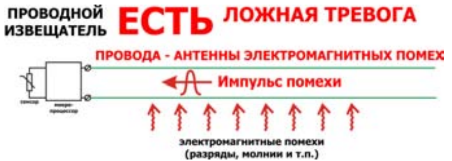
Рис.2. Воздействие электромагнитных помех на проводные извещатели.
