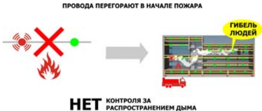
Рис.4. Отсутствие возможности управления эвакуацией после начала пожара
